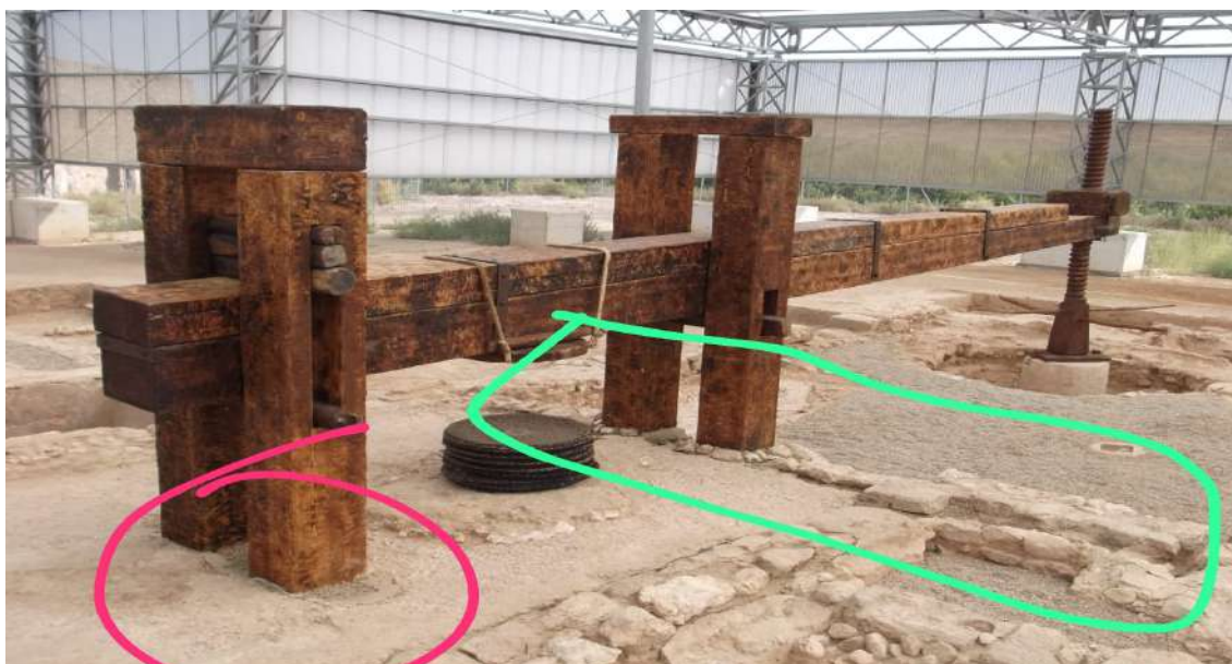
Fot. 23: Reconstrucción de almazara de aceite romana en el yacimiento de Loma del Regadío (Urrea de Gaén-Teruel). Prensa con los pies de prensa o Lapis pedicinarum señalados en color.
